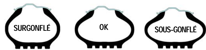
Une pression de gonflage appropriée donne aux pneus la forme qui convient pour assurer une usure lente et régulière et une économie optimale de carburant.
